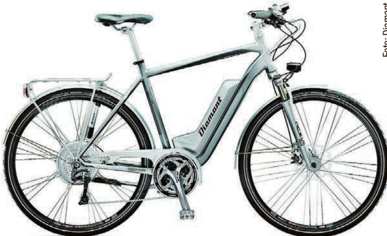
Alle Kraft am Hinterrad: Diamant Zouma Elite Plus mit Heckantrieb und Akku am Rahmenunterzug
